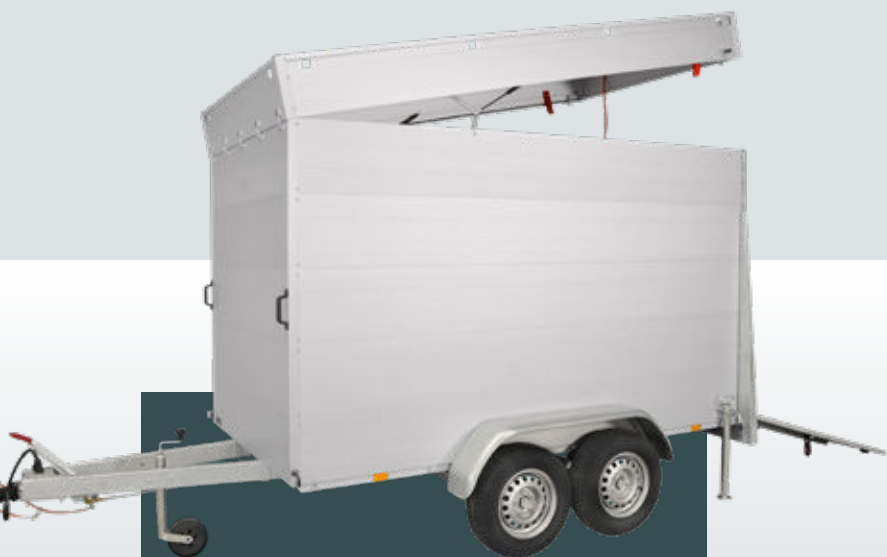
VT4 met een binnenhogte van 188 cm Bindrail op 5 hoogtes, standaard aantal meegeleverde bindogen 8 stuks
