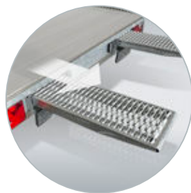
Stalen rijplaten van 250 cm onder laadvloer
